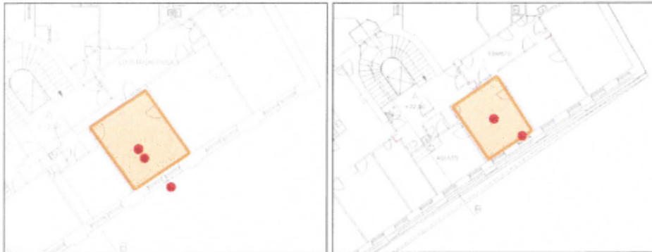
Kuvat 1 ja 2. Vasemmalla hoitokeskuksen huonetilassa olevat mittauspisteet (3. krs) sekä kadulta julkisivulle nostettu ulkomelun mittauspiste. Oikealla arkkitehtitoimiston huonetilassa olevat mittauspisteet (6. krs).
