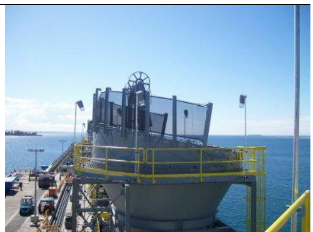
Kuva 12. Suppilon muotoilu ja erillinen tuulisuoja.
