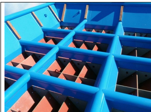
Kuva 11. Passiivinen pölynhallinta suppilon rakenneratkaisuilla.
