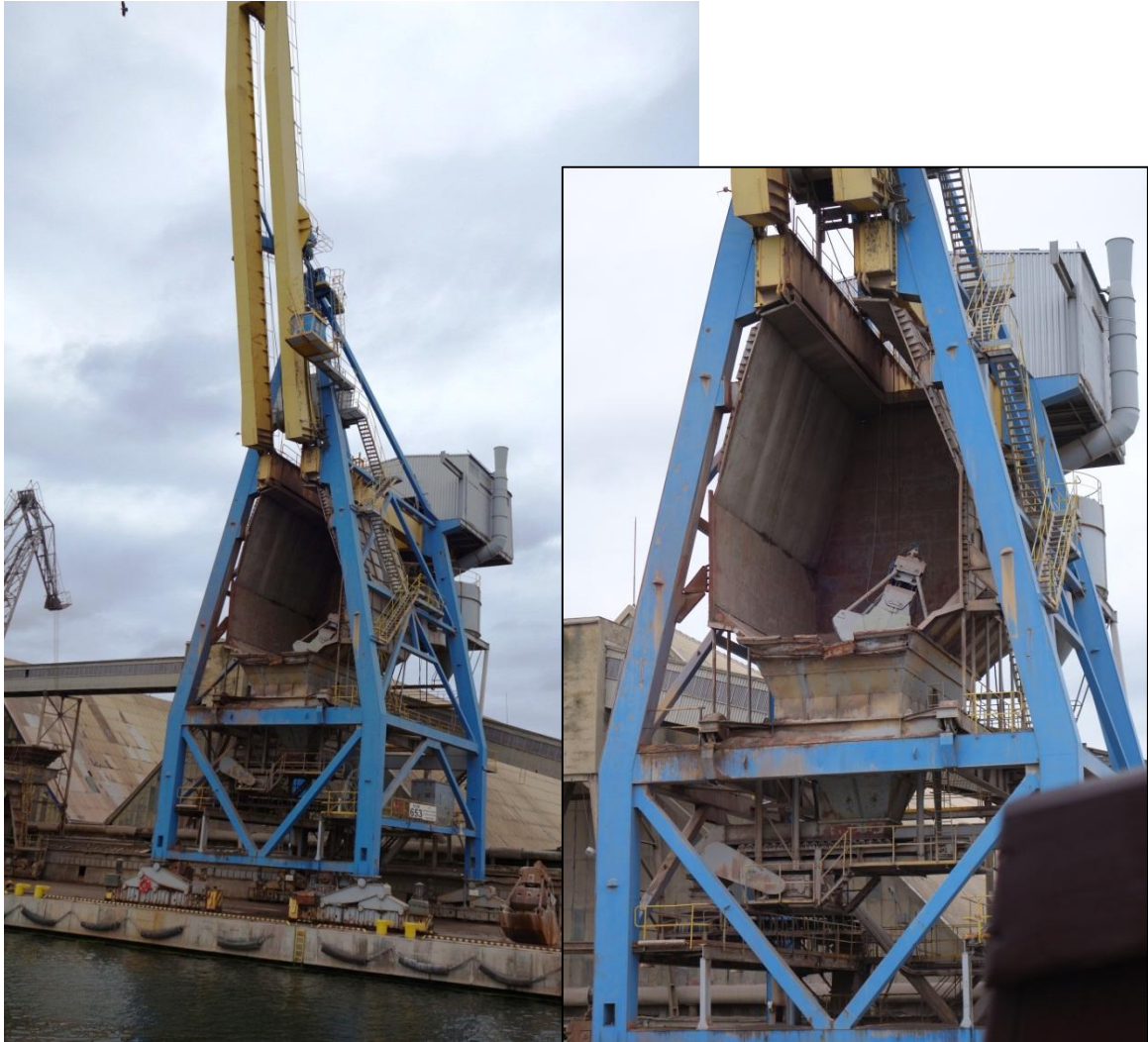
Kuva 10. Tuulisuojaus pukkinosturin suppilossa (kuva: Matti Utriainen).
