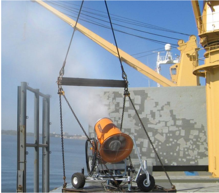
Kuva 16. Pölynhallinta vesisumulla (kuva: Port of Panama City).
