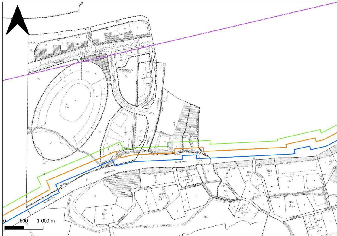
Kuva 5-12. Linjausvaihtoehdot asemakaavojen 753001 ja 753009 alueilla. Linjausvaihtoehdot VE2, VE3 ja VE5 on esitetty rinnakkain kulkevinä, todellisuudessa vaihtoehdot kulkevat linjalla VE2 (sininen linja). Lähde: Helsingin karttapalvelu, 2021.
