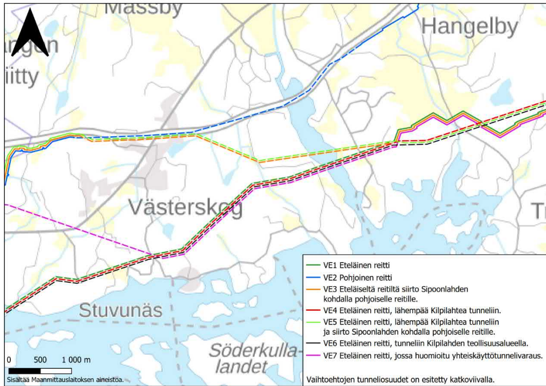
Kuva 2-3. Tarkasteltavat vaihtoehdot VE1–VE7, hankealueen keskiosa. Vaihtoehtoiset reitti-linjaukset on esitetty kartalla havainnollisuuden vuoksi niiltä osin rinnakkain, kun linjaukset menevät samaa reittiä. Kallioperässä tunnelissa kulkevat putkiosuudet on esitetty katkoviivalla, maaputkiosuudet yhtenäisellä viivalla.
