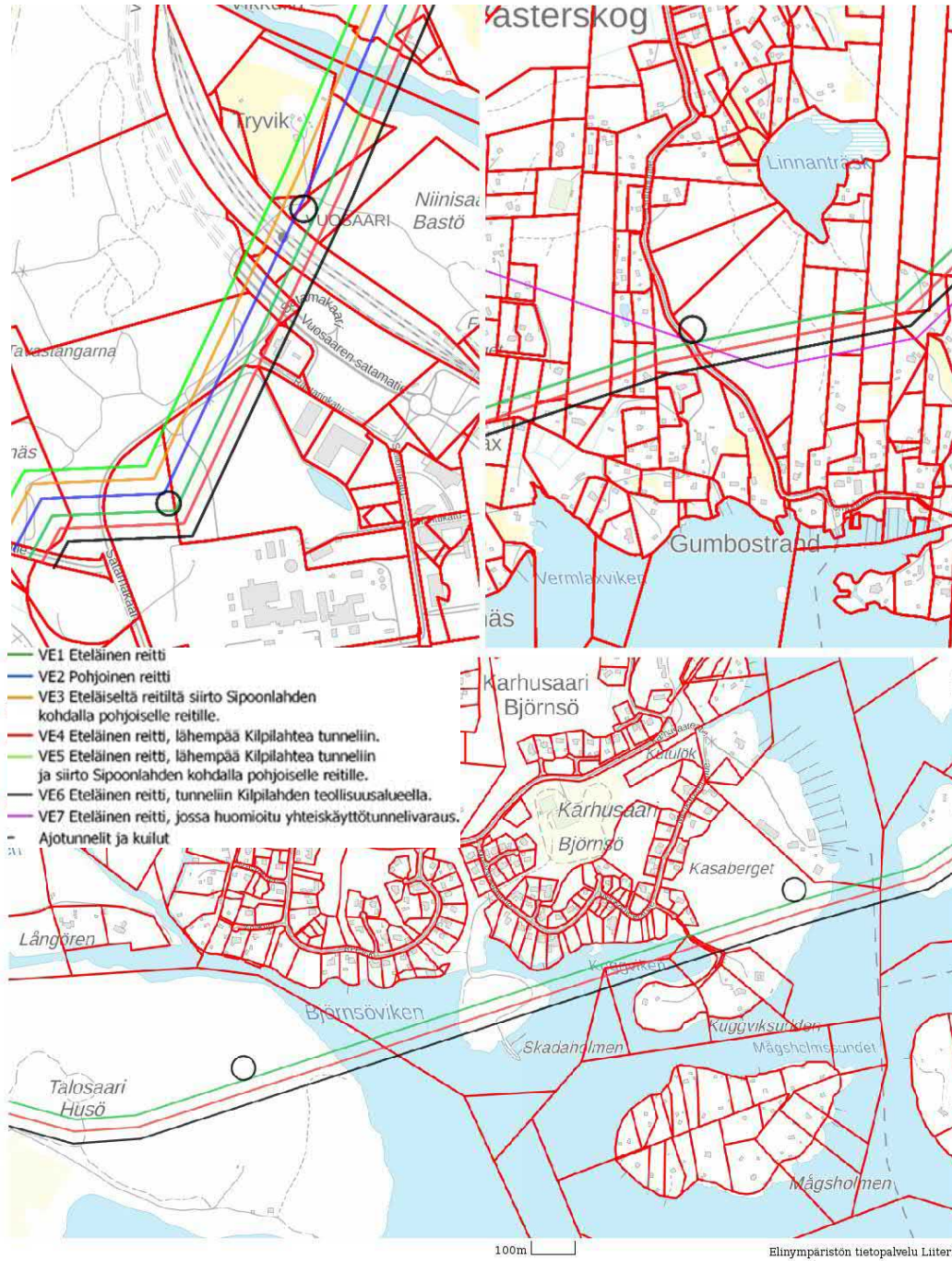
Kuva 5-24. Pystykuilujen sijainnit. Pystykuilut esitetty kuvissa mustilla ympyröillä. Linjausvaihtoehdot VE1, VE4 ja VE6 on esitetty rinnakkain kulkevana, todellisuudessa vaihtoehdot kulkevat linjaa VE1 (tummanvihreä linja). Linjausvaihtoehdot VE1-VE6 on esitetty rinnakkain kulkevana, todellisuudessa vaihtoehdot kulkevat linjaa VE1 (tummanvihreä linja). Lähde: Elinympäristön tietopalvelu Liiteri 2021.
