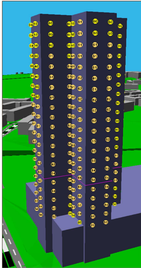
Kuva 22. Yhteismelusta aiheutuvat päiväajan keskiäänitasot L_{A,eq7-22} toimisto- ja hotellikerrosten julkisivulla
