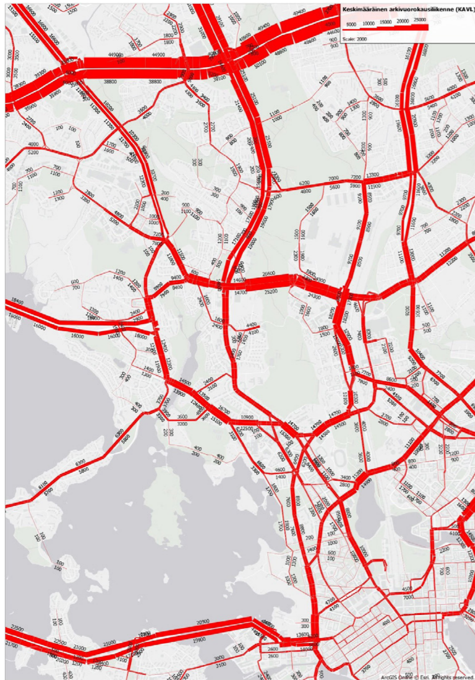
Kuva 45. Ennustettu keskivuorokausiliikenne vuonna 2030 vaihtoehdossa VE 2+ liikenteen hinnoittelutoimenpitein
