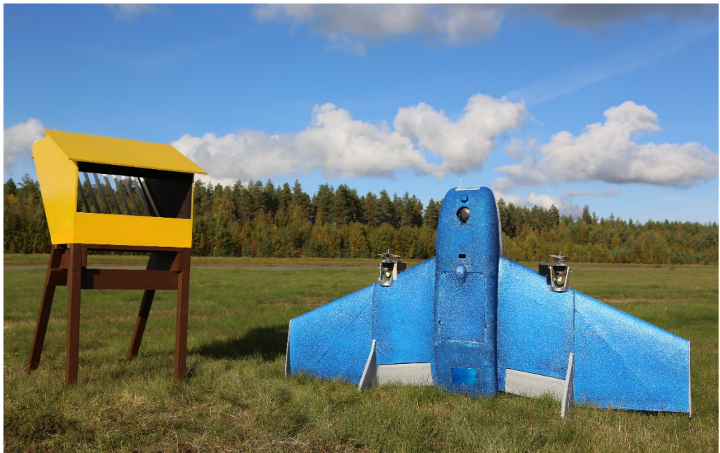
Kuva 4. Lentola Logictis Oy:n kehittämä sähkökäyttöinen Vertical Take-Off and Landing (VTOL) ilma-alus. (Lähde Lentola Logistics Oy, sähköpostiviesti 9.12.2019)
