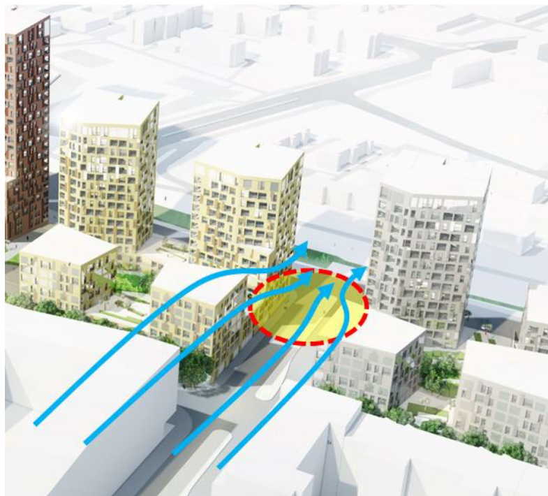
Kuva 20: a) Kohteen aukion tuulisuusolosuhteita voidaan parantaa mahdollisuuksien mukaan puilla, penssilla ja katutason virtaukseen kitkaa tuottavilla rakenteilla. Tornin maahan ulottuva kulma on tuulisuuden suhteen yleensä ongelmallinen, ja siinä liikkumista voitaisiin ohjata muualle. b) Tornien väliin ei ole suositeltavaa sijoittaa erityistä viihtyisyyttä edellyttäviä toimintoja. Kuvat on muokattu Arkkitehtuuritoimisto B & M Oy aineistoon.
