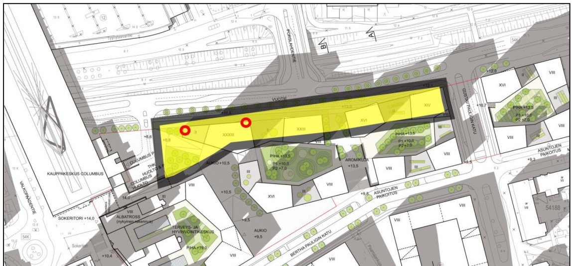
Kuva 1. Alue, jolla metrol iikenteen aiheuttama runkomelu saattaa ylittää suositusarvot (keltainen) ja suositellut mittauspisteet (punaiset ympyrät).
