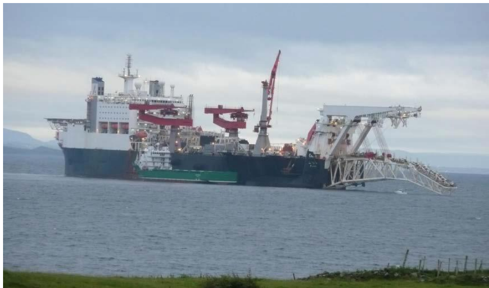
Kuva 2-2. Suomenlahdella käytetty putkenlaskualus Solitaire .
