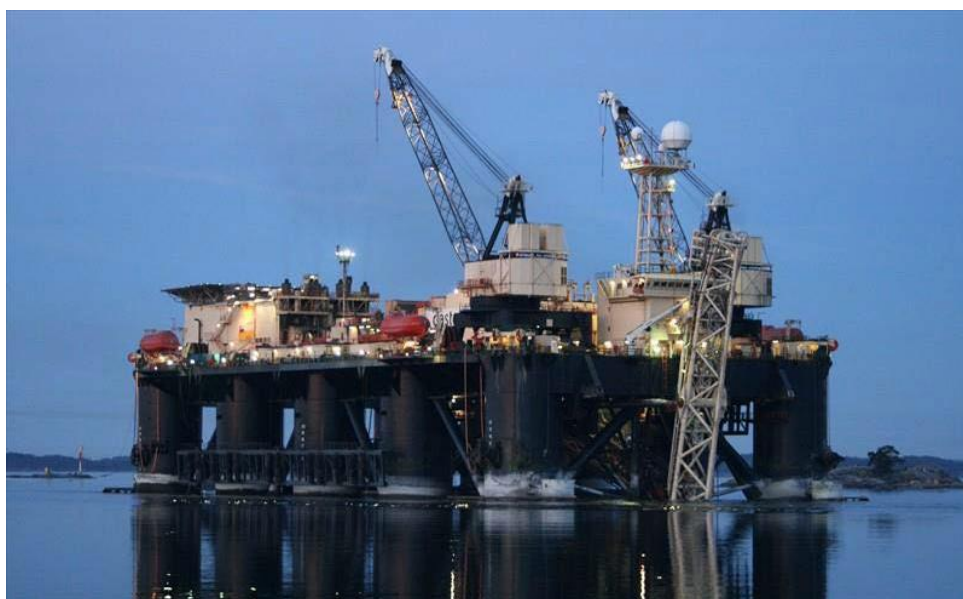
Kuva 2-3. Suomenlahden ulkopuolella käytetty putkenlaskualus Castoro Sei .
