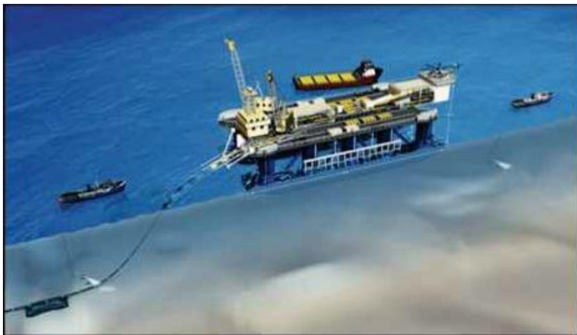
Kuva 6-11 S-asennukseen käytettävä putkenlaskualus ja tutkimusalukset.
