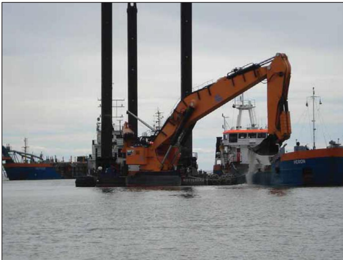
Kuva 6-16 Kauharuoppaaja, jonka viereen on ankkuroitu palkoproomu (oikealla).
