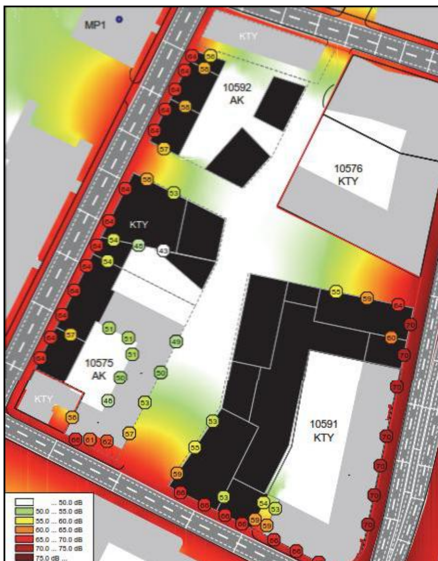
Kuva 15. Julkisivuille kohdistuvat ajoneuvo- ja raitioliikenteen päiväajan melutasot ( L_{Aeq\ 7-22} ), kun Sörnäisten tunnelia ei ole toteutettu ja korttelissa 10575 makkaratehtaan rakennus säilytetään.
