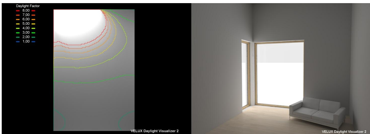
Kuva: Esimerkki asuinhuoneen ikkuna-aukotuksesta ja päivänvalokertoimesta (daylight factor). Arkkitehtuuritoimisto Kimmo Lylykangas Oy, SunZEB-hanke 2015.
