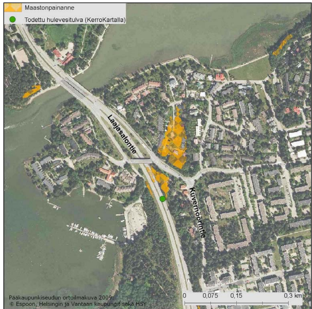
Kuva 58. Laajasalontielle havaittu toistuva hulevesitulva
