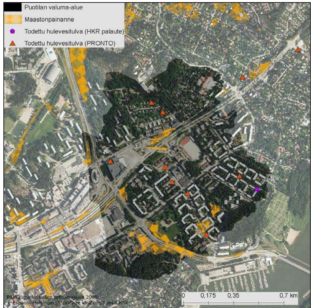
Kuva 39. Puotilan mallinnettu valuma-alue sekä alueella todetut hulevesitulvat ja maastonpainanteet.
