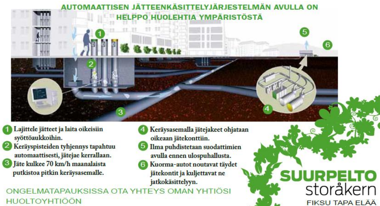
Kuva 1 Automaattisen jätteenkäsittelyjärjestelmän toimintaperiaatteet
