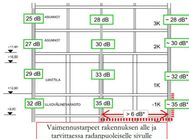
Kuva 3. Poikkileikkaus runkomelueristeen periaatteellisesta sijoittamisesta kohteessa Retkeilijänkatu 1 . Jotta tähdellä * merkityt arviot toteutuisivat, oletetaan kuvan 2 osoittamat lähtötasot sekä vähintään 6 dB runkomelueristys rakennuksen alle osoitetulle alueelle.
