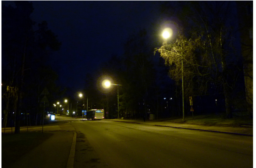
Kuva 12. Katuvalaistus ei saa aiheuttaa häikäisyä ja luminanssin tasaisuuden tulee olla riittävä. Puiden varjostava ominaisuus on otettava huomioon suunnittelussa. (Kuva: Ulla-Kirsti Junttila/Sito Oy)
