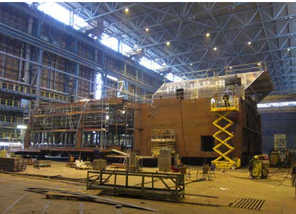
Laivalohkon työstö Suurlokkohallissa 2011
