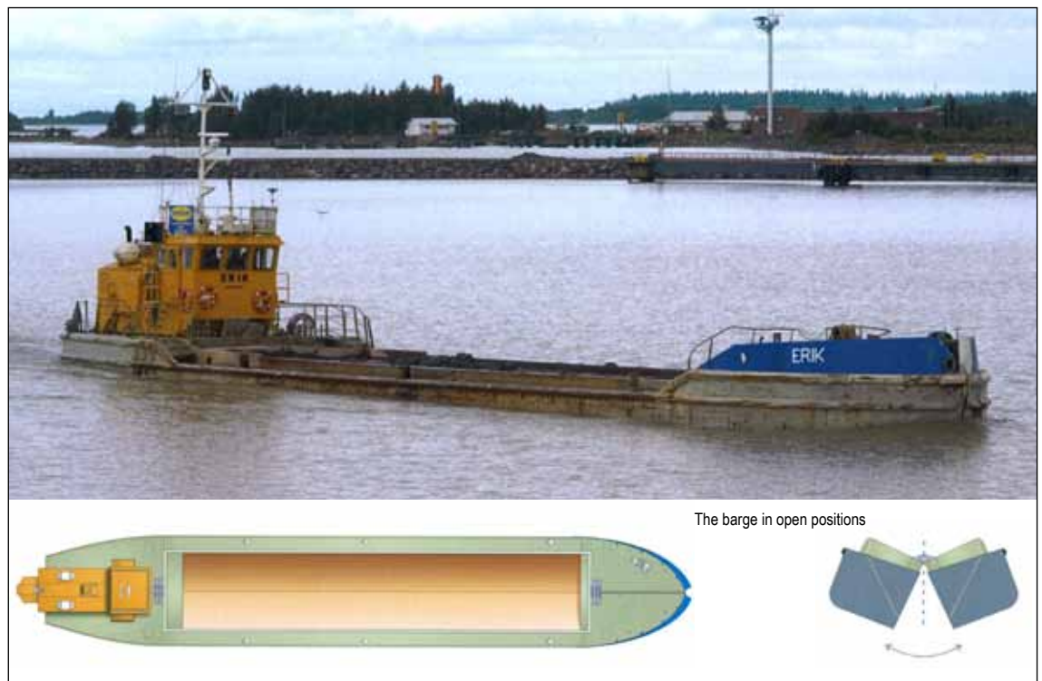
Kuva 3. Esimerkki pienissä läjitystöissä (lastin maksimimäärä noin 270 m 3 ) käytettävästä, itsekulkevasta proomusta. (Lähde: Terramare Oy)
