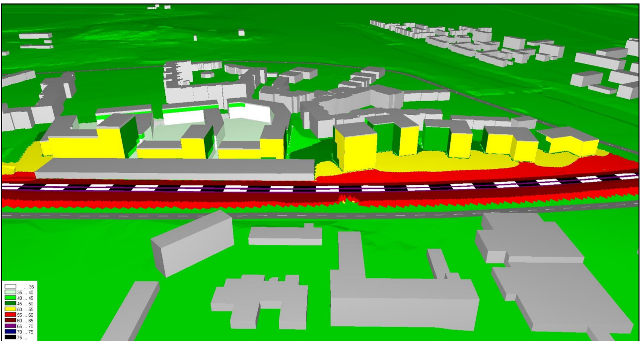
Kuvat A3. Julkisivuihin ja pihoilte kohdistuvat päivä- (ylä) ja yöajan (ala) keskiäänitasot laskettilanteessa VE1 ilman meluestettä radan varrella.
