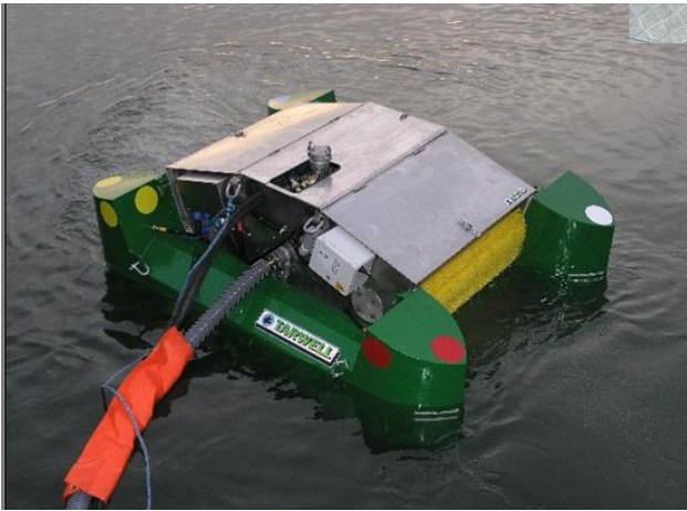
MABS: monitoiminen skimmeri, jääkeräyksessä käytetään nosturista riiputtaen.
