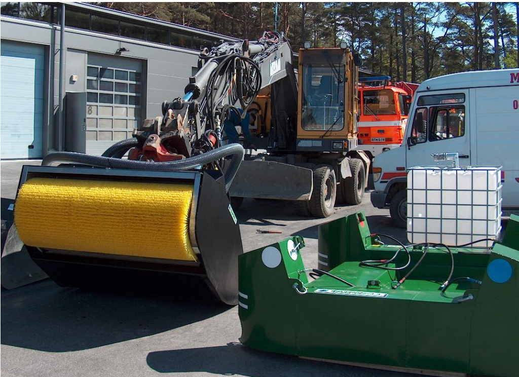
MOBS: monitoiminen skimmeri, jääkeräyksessä käytetään nosturista riiputtaen tai öljynkeräyskauhana kaivinkoneesta
