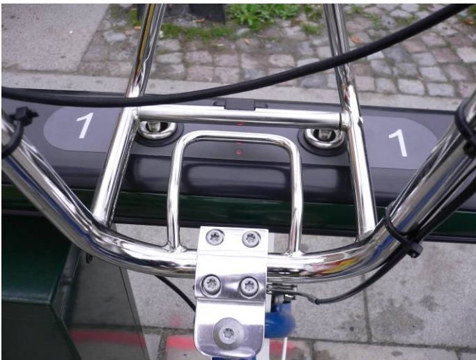
Kuva 15 Tukholman kaupunkipyörän ohjaustanko ja lukitusjärjestelmä
