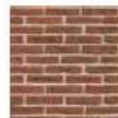
1. Palkalla muurattu tiili, punaruskea (KATU)
