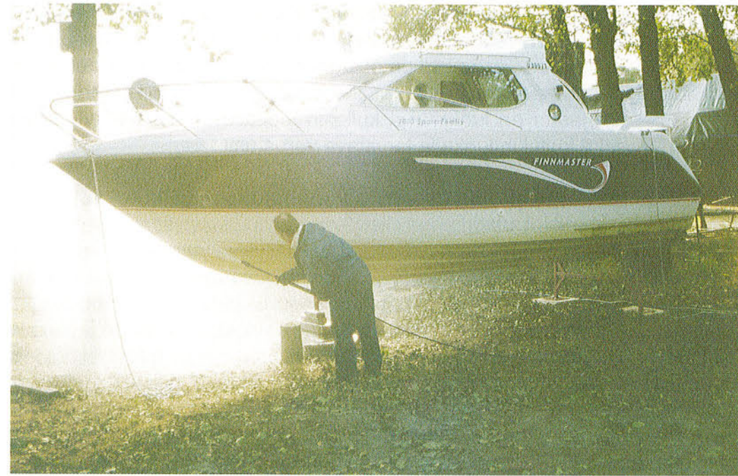
Kuva 19. Veneen pohjan pesu noston yhteydessä on syyshuollon tärkeimpiä toimenpiteitä. Pääsääntöisesti pesu tehdään painepesurin avulla pelkällä vedellä. Mustalahden venesatama. Kuva H. Airola.
