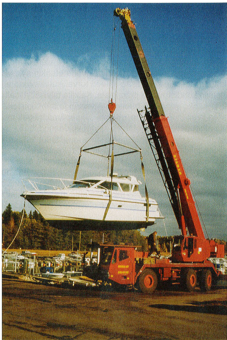
Kuva 31. Talvisäilytysalueiden rantarakenteet ja kulkuväylät tulee mitoittaa raskaan nosto- ja kuljetuskaluston toiminnan mukaisiksi. Sarvaston venesatama. Kuva H. Airola.
