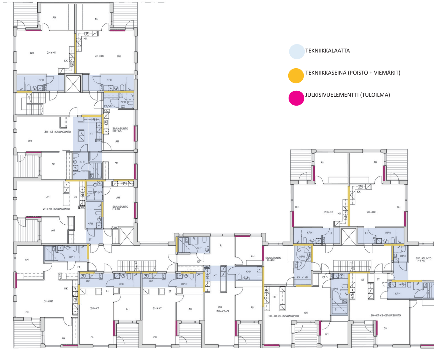
Esimerkkikortteliin on yhdistetty aikaisemmin testattuja talotyyppejä mutta sisäänvedetyillä parvekkeilla. Myös tämän kaltaiseen, jopa kahdeksan kerroksiseen, rakennukseen järjestelmä nähtiin soveltuvan.
