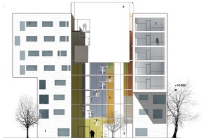
Porrashuonetta voidaan kehittää monin tavoin, mm. sen julkisuusastetta ja tunnelmaa. Esimerkki kilpailuehdotuksesta, jossa porrashuone on valon tilan ja värin keskittymä, joka näkyy myös ulos. Porrashuoneen ja asuntojen välisistä ovista ulommainen on lasiovi, jolloin halutessa saadaan näkymiä ja valoa myös porrashuoneen suunnasta. Porrashuoneessa on väljyyttä ja tilaa merkitä oma yksityinen alue. Vaihteleva ja vaihdettava julkisivukäsittely sisäänkäyntien yhteydessä personoi asuntoja ja synnyttää pienempää mittakaavaa. Asukas voi merkitä ja nähdä oman ulko-oven ja jo kaukaa. Arkkitehtitoimisto Nurmela, Raimoranta, Tasa Oy, 2003.
