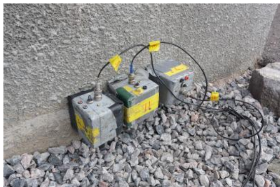
Mittauspisteet A10x, A11y ja A12z. Anturit on liimattu porraskuilurakennuksen sokkeliin
