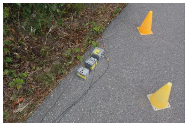
Mittauspisteet B7x, B8y ja B9z. Anturit on liimattu asfalttiin.
