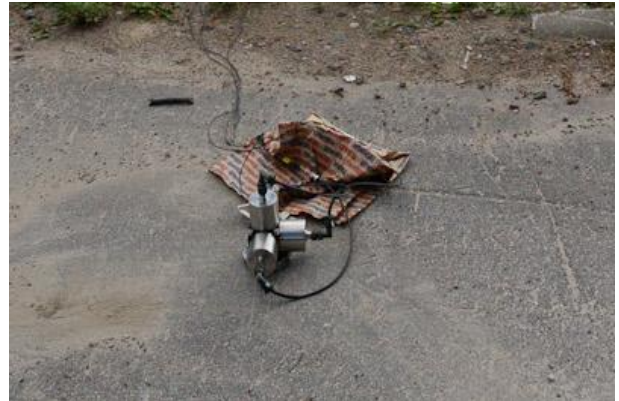
Mittauspisteet A1x, A2y ja A3z. Anturit on liimattu asfalttiin.
