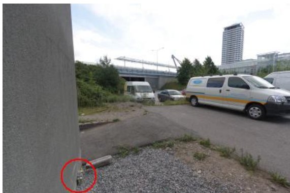
Mittauspisteet A10x, A11y ja A12z. Anturit on liimattu porraskuilurakennuksen sokkeliin
