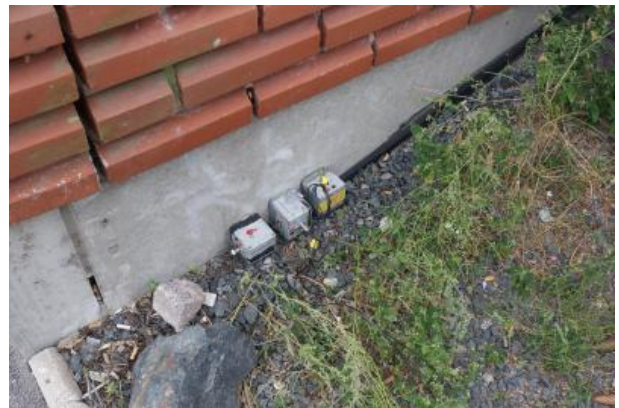
Mittauspisteet B4x, B5y ja B6z. Anturit on liimattu Tyynyläavantie 13:n kaakkoisnurkan sokkeliin.
