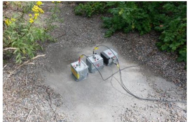
Mittauspisteet A4x, A5y ja A6z. Anturit on liimattu asfalttiin.
