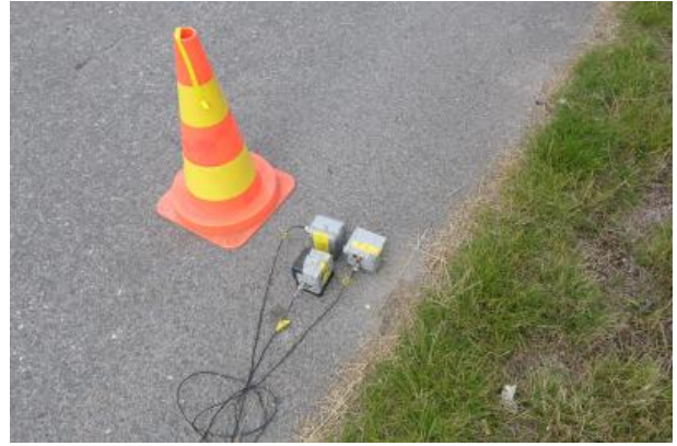
Mittauspisteet B10x, B11y ja B12z. Anturit on liimattu asfalttiin.
