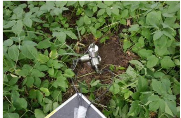
Mittauspisteet B1x, B2y ja B3z. Anturit on asennettu maaruovin päähän.
