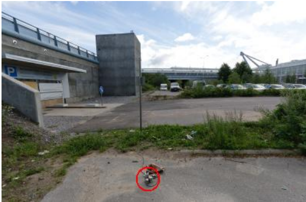
Mittauspisteet A1x, A2y ja A3z. Anturit on liimattu asfalttiin.
