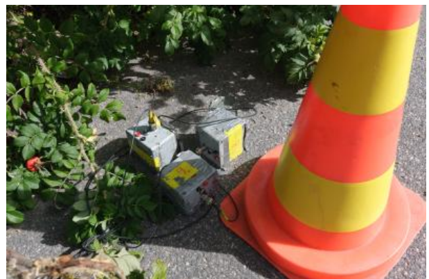
Mittauspisteet A7x, A8y ja A9z. Anturit on liimattu asfalttiin.
