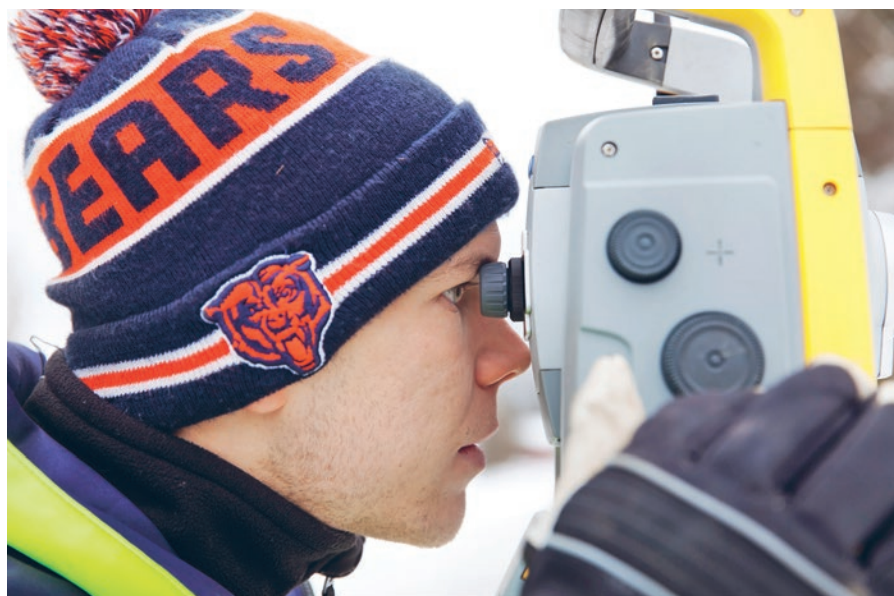
Vastaava kartoittaja Aimo Pyykkönen mittaa kohteen sijaintia takymetrin avulla.
