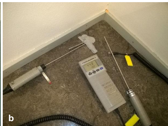
Kuvat 8a ja b. Kuvissa on esitetty viiltomittausjärjestelyt mittapisteissä V3 (59,7 %RH) ja V5 (44,8 %RH). Viiltomittauskohdan vieressä olevalla mittapäällä mitattiin sisäilman olosuhteet viiltomittaushetkellä.
