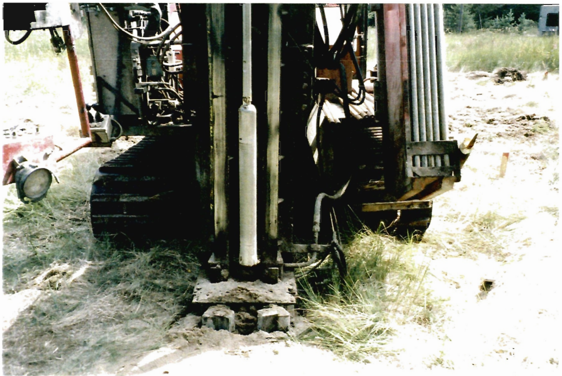
Kuva 6.3 Näytteenotto R - näytteenottoputkella
