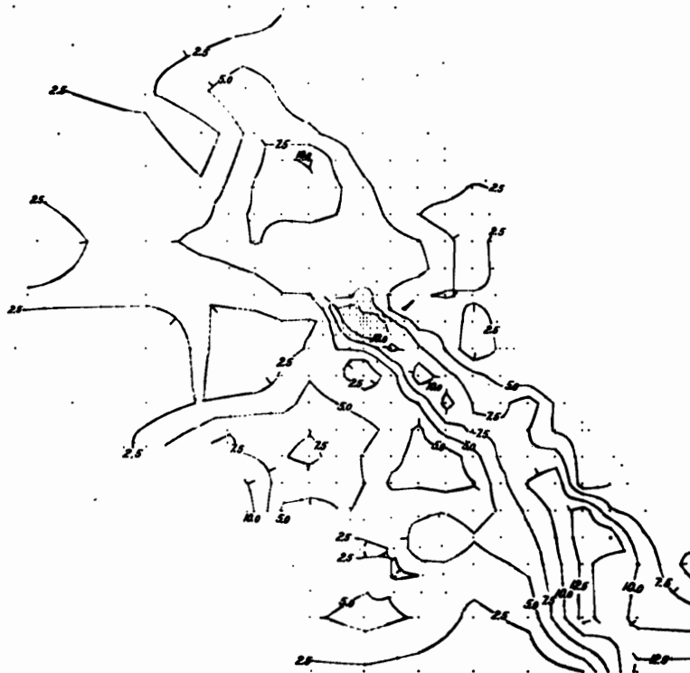
Kuva 40. Alemman vettä hyvin läpäisevän kerroksen paksuus pumppauskohdan ympäristössä.
