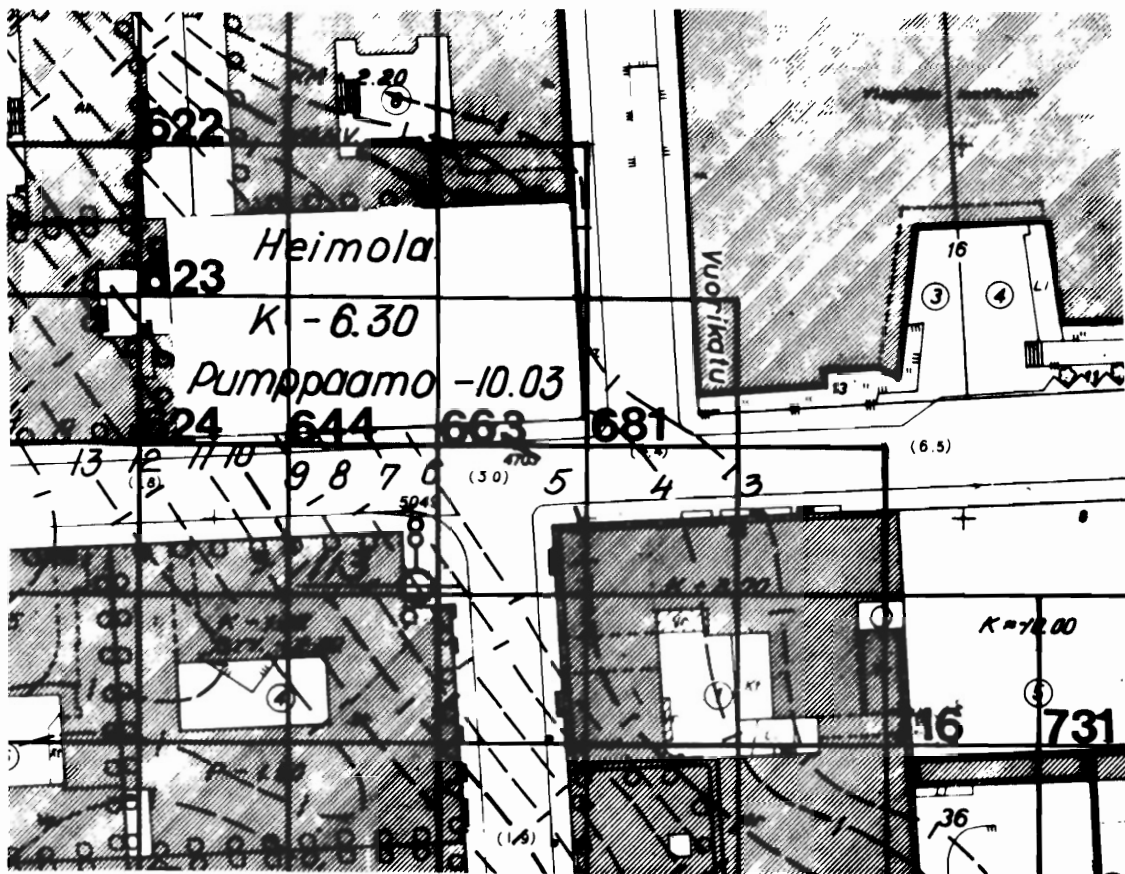
Kuva 58. Elementtiverkon solmupisteet, joihin on asetettu Heimolan talon ja yliopiston hallintorakennuksen vuodot.
