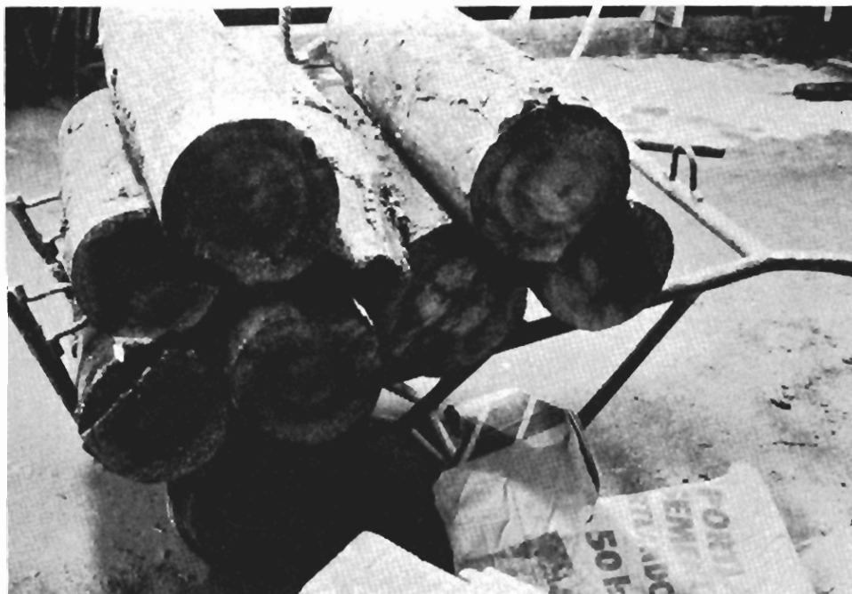
Kuva 17. Saven ympäröiminä olleet paalun osat ovat säilyneet terveinä.
