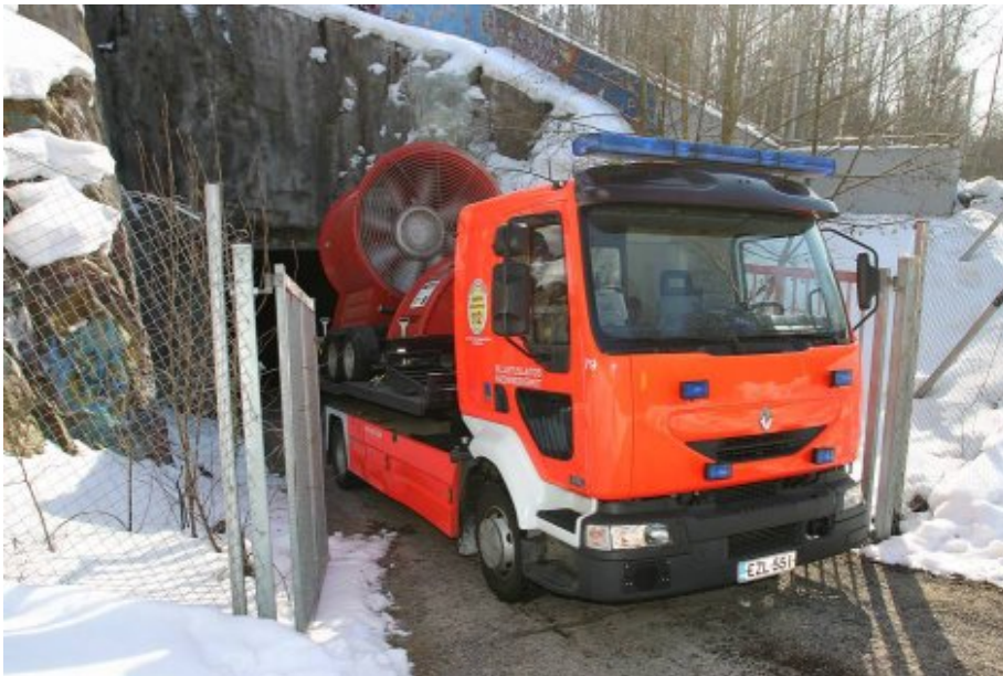
Kuva 35: Helsingin kaupungin pelastuslaitoksen suurtehopuhaltimen toiminnassa kuljetusauton lavalla (Marko Järvinen, Helsingin kaupungin pelastuslaitos)
