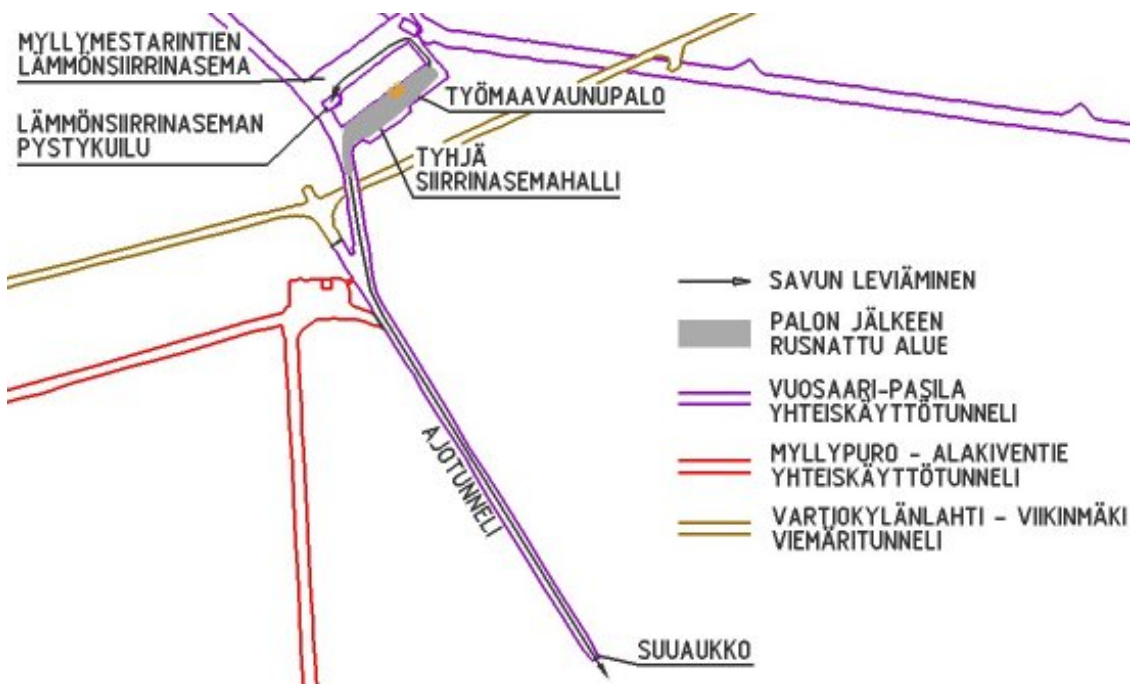
Kuva 20: Myllypuron vaunupalon savun leviäminen ja palon jälkeen rusnattu alue
