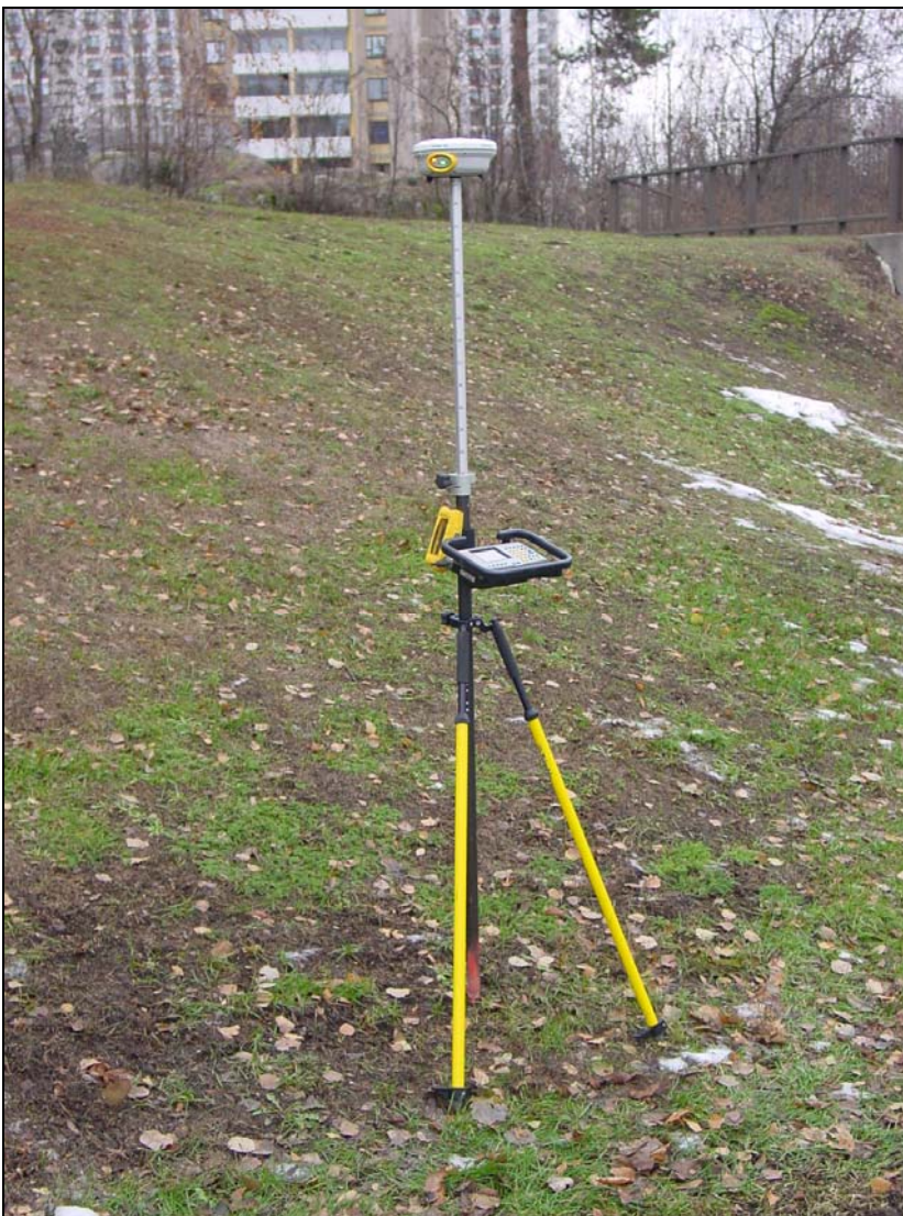
Kuva 7: Trimble 5800 vastaanotin, ACU-tallennin ja GSM-puhelin liitettyinä tukijaloilla tuettuun kartoitussauvaan
