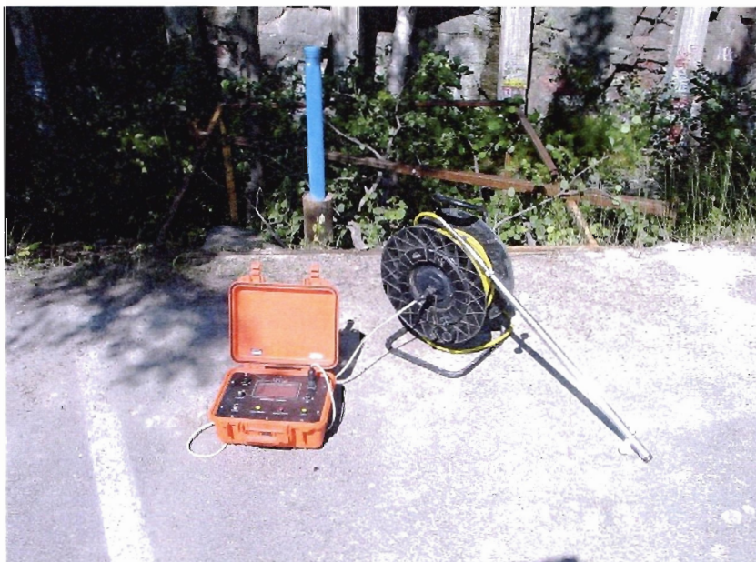
Kuva 10. Inklinometrilaitteisto sekä sivusiirtymäputki
