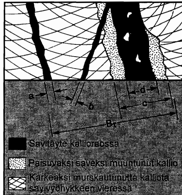
Kuva 4.2. Savikerroksen paksuuden määrittäminen kenttäolosuhteissa. Jos paisuvaa savea on vain rakotäytteissä, B_t = a + b + d . Jos esiintyy kahden tyyppistä paisuvaa savea, B_t on a + b + d ja c - d vastaavasti. B_t on vyöhykkeen kokonaispaksuus (Selmer-Olsen 1990).
