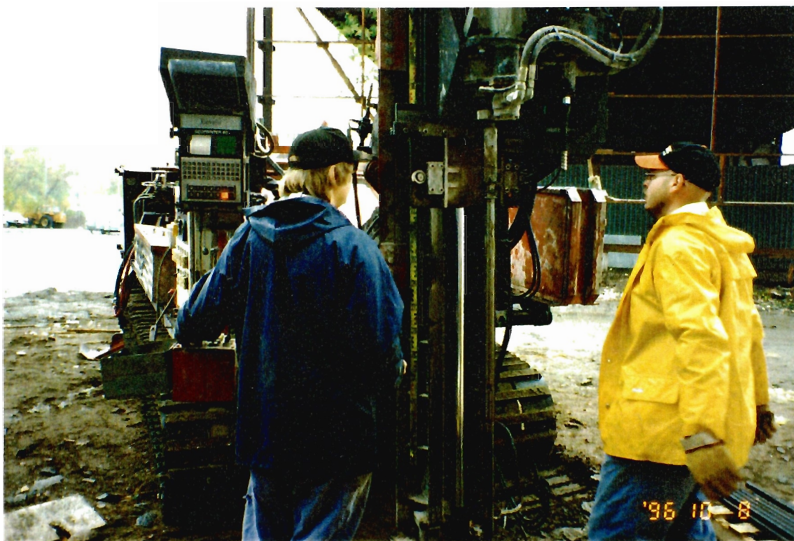
Kuva 2.2. Puristin-heijarikairausta GM 4000-4 -kairauskoneella Myllypellon koealueella.
