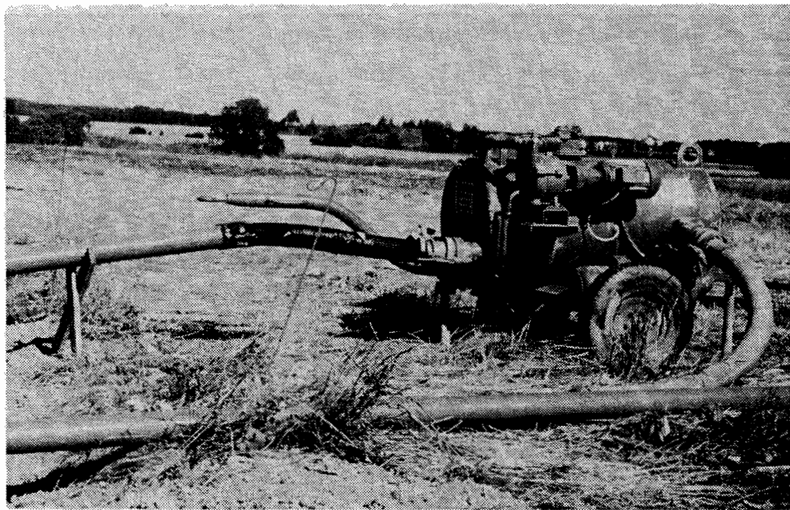
Kuva 3.19 Torpparinmäen vakuumikonsolidointikokeilussa käytetty 90 kPa:n alipainepumppu.
