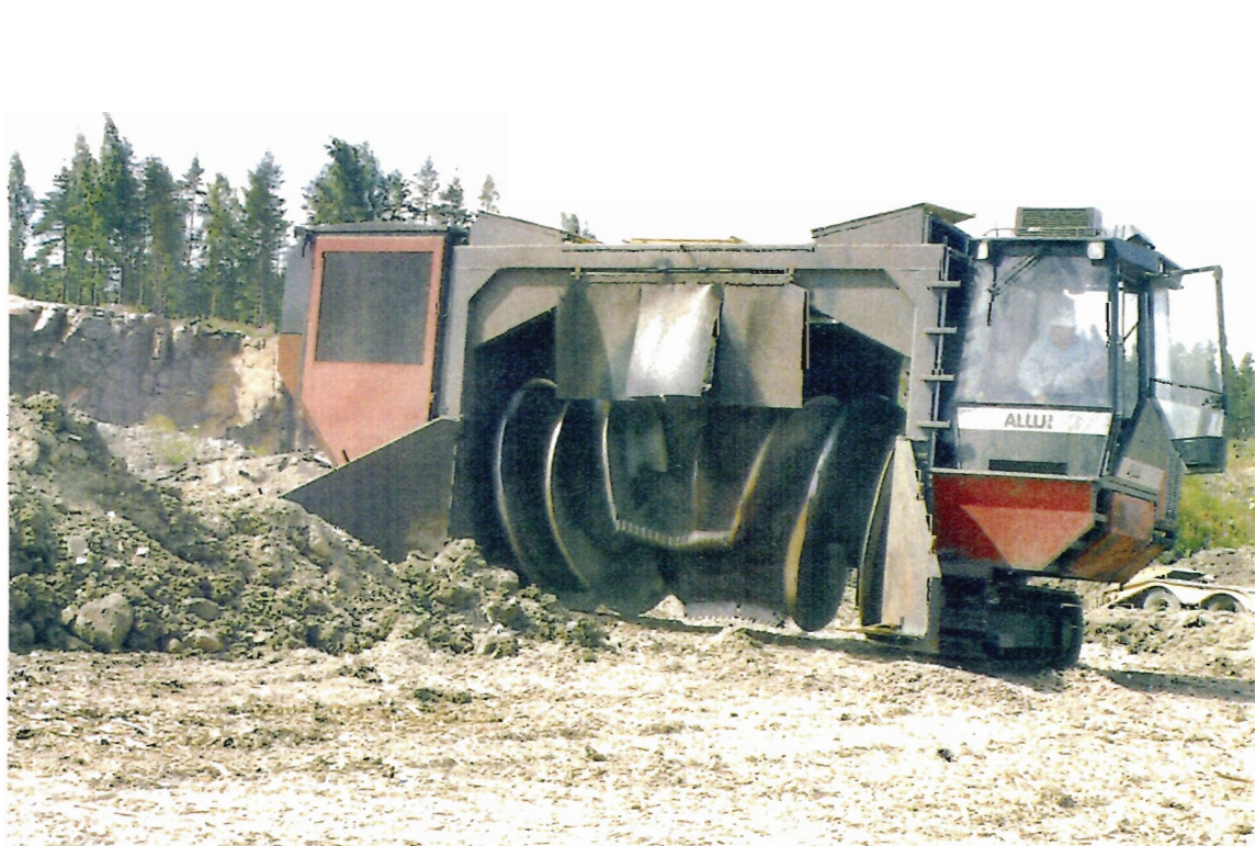
Kuva 26. Lähikuva Allu AS -tyyppisestä aumasekoittimesta.
