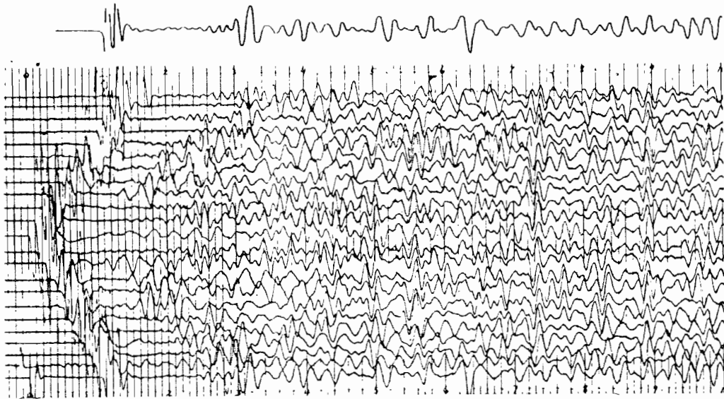
Kuva 34. Tyypillinen refraktioluotauksen UV-piirturilla saatu tulostus. Kuvasta on pystyttävä määrittämään ensimmäiset P-aallot.
