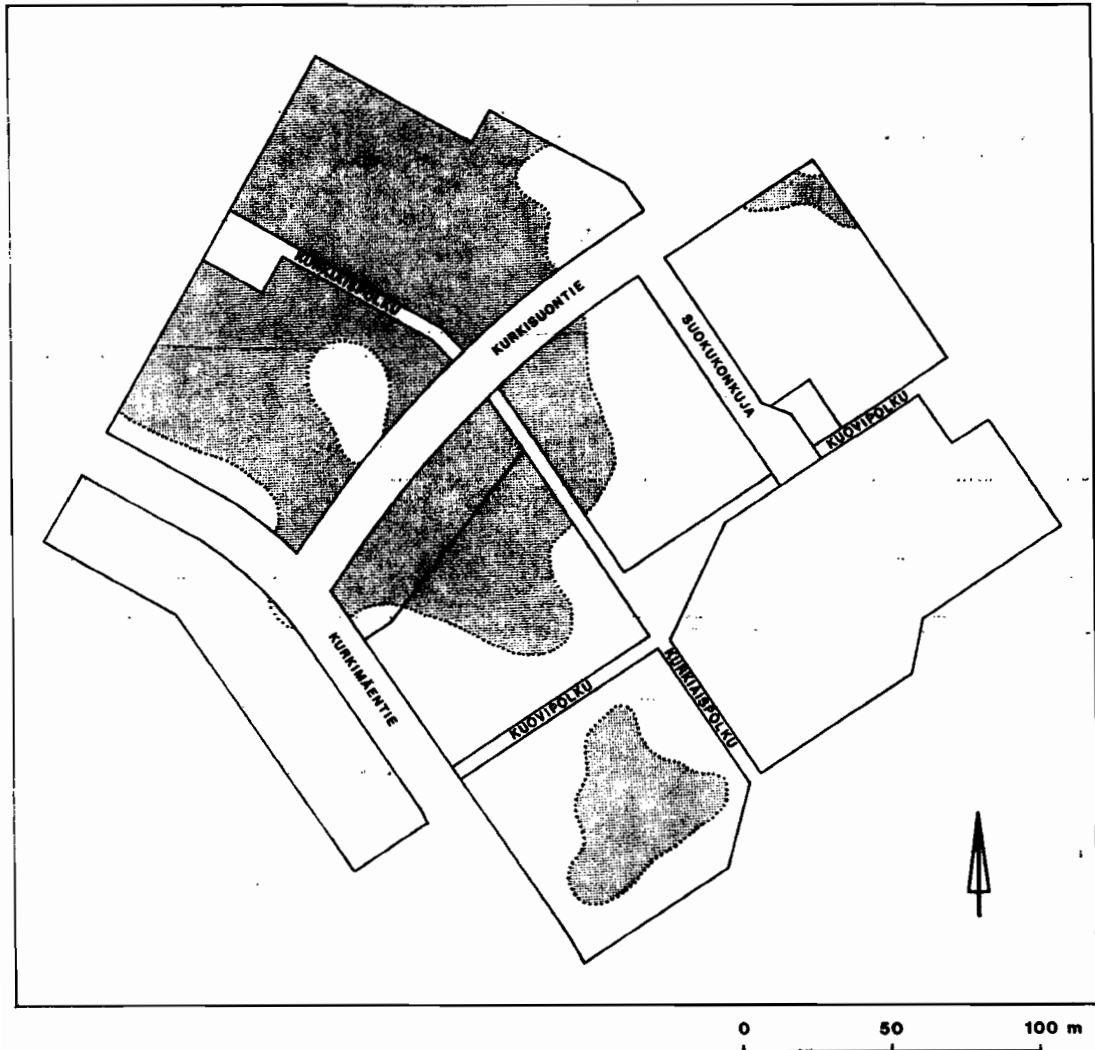
Kuva 19. Kurkimäen III alueen asemapiirros. Massanvaihto on toteutettu alueellisena esirakentamisena rasteroidulla alueella (turvetta vähintään 0,5 m).
