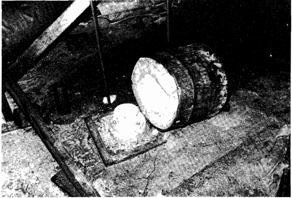
Kuva 45. Ekstensometrin E 1 mittauspään suojaus.
