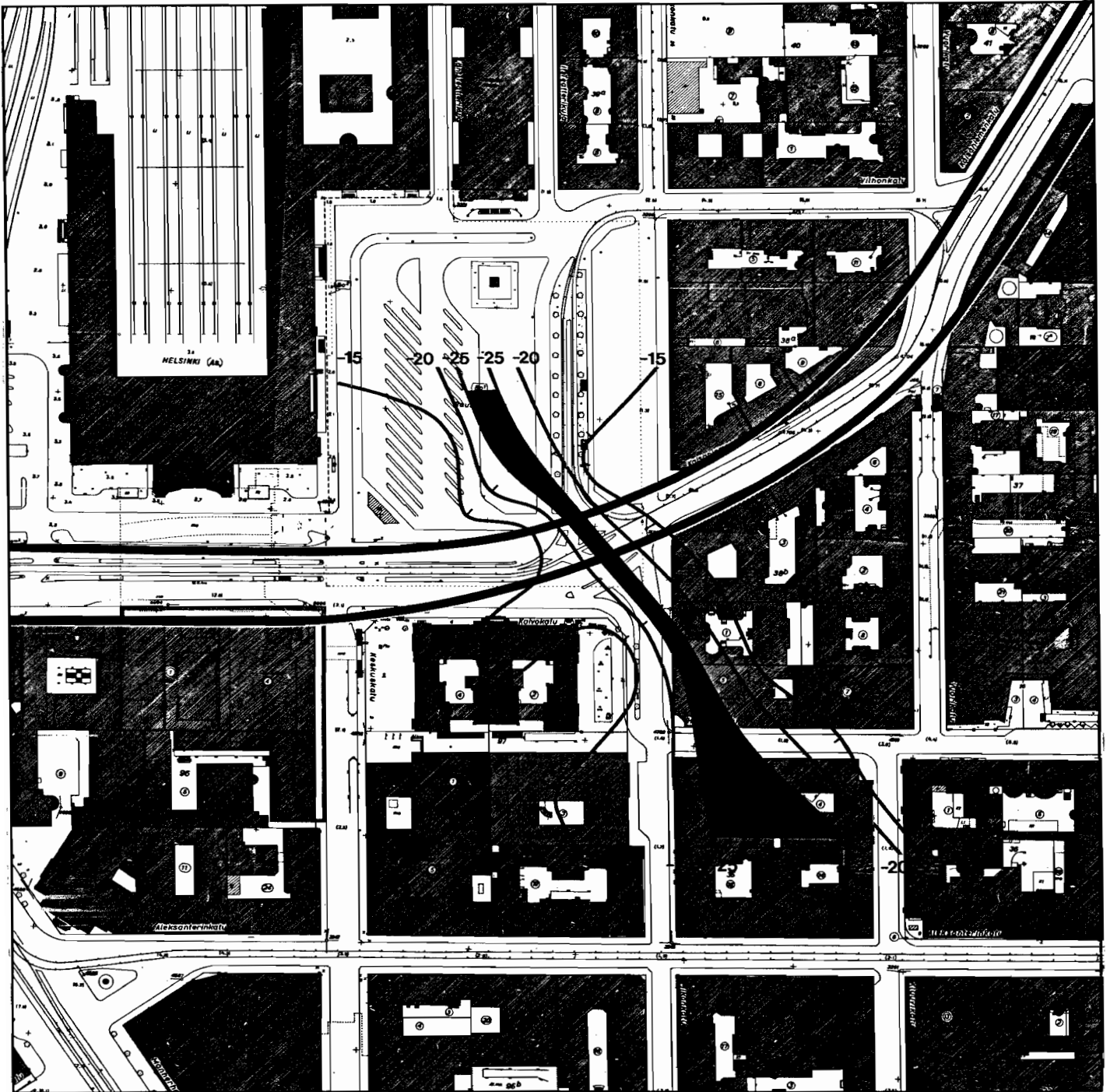
Kuva 2. Kluuvin ruhjeen sijainti. Kallionpinta ruhjeen kohdalla merkitty korkeuskäyrillä. Metron rata-tunnelit leikkaavat ruhjeen kohtisuorasti.
