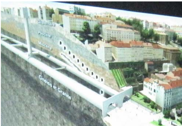
Olemassa oleva autoliikennetunneli (vas.) ja rakenteilla oleva "pehmotunneli" (oik.) sijoittuvat kovaan gneissi/graniittikallioon
