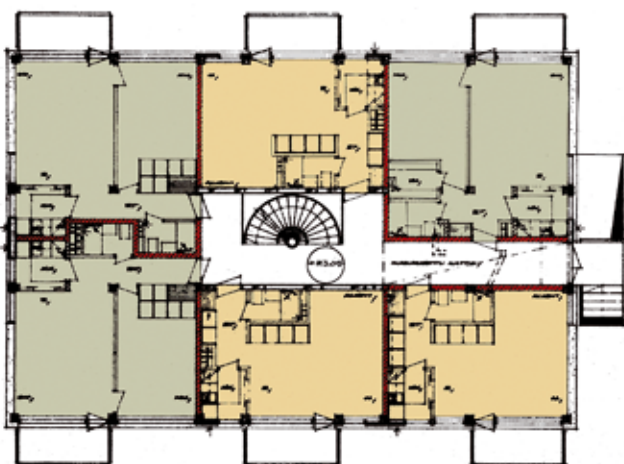
As Oy Konalanvuoren asuintalon ensimmäinen kerros. Asuntotyytit ovat pieniä, 31 m 2 :n yksiöitä ja 43,5 m 2 :n kaksioita. Päädyn sisäänkäynnin alta johtavat portaat kellarisiin, jossa sijaitsevat sauna-, varasto- ja muut aputilat.
