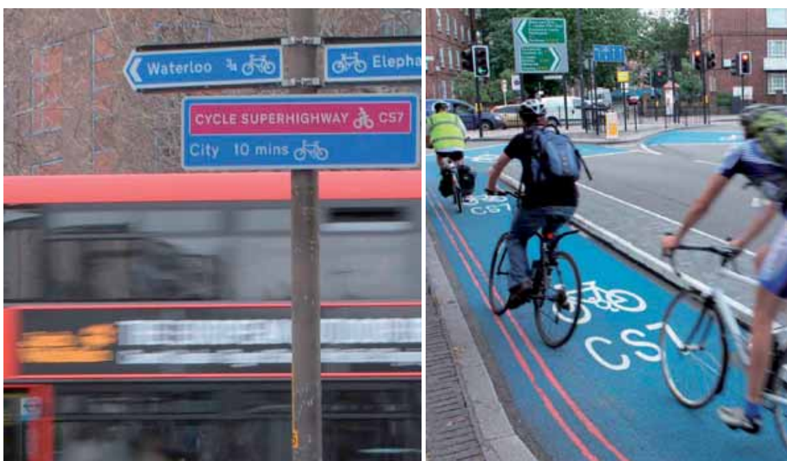
Kuva 5. Lontoossa laatukäytävien tunnusomaiset värit on esitetty sekä viitoissa että päällysteessä. Lisäksi laatukäytävät on selkeästi numeroitu myös päällysteeseen.
