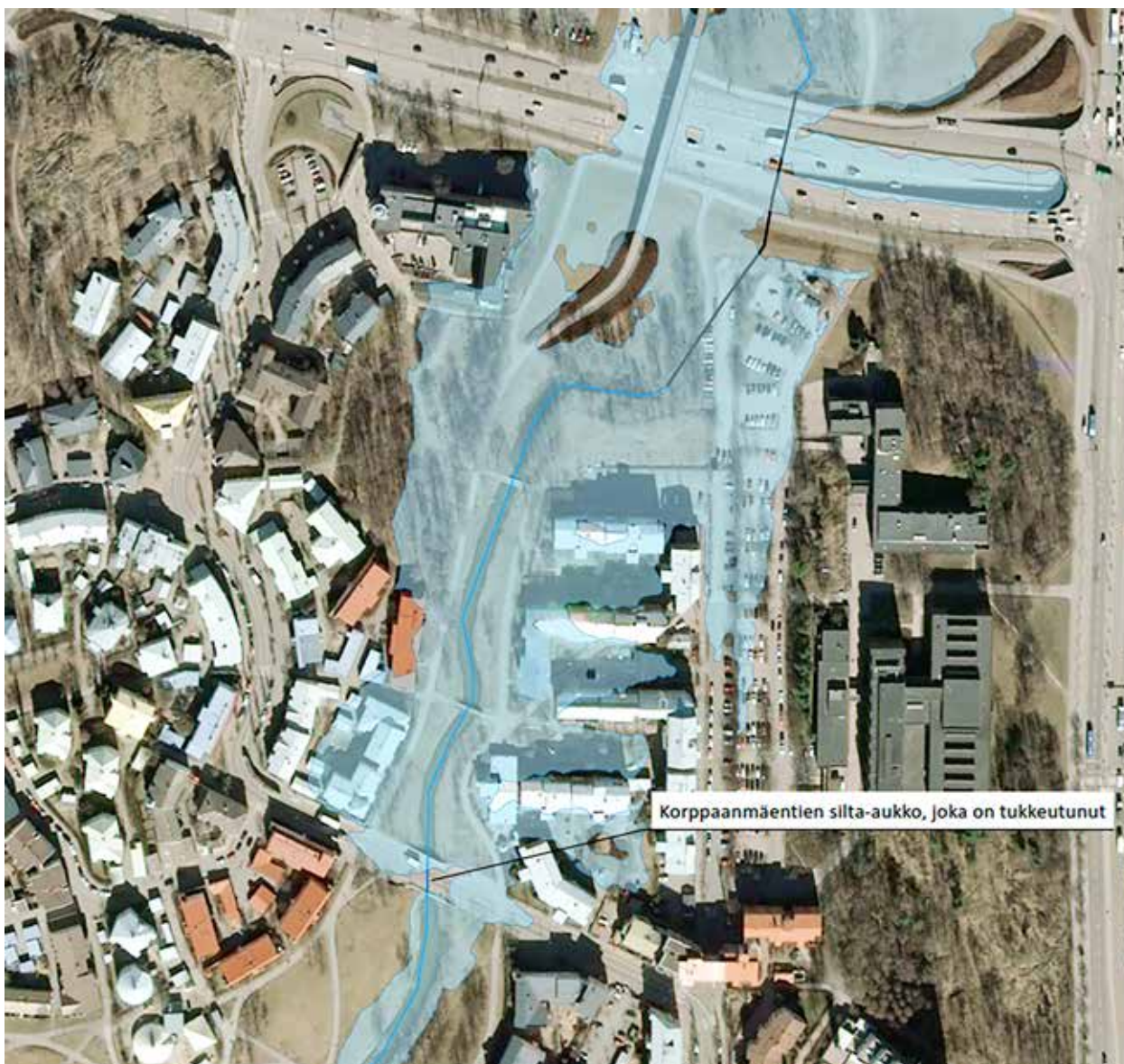
Kuva 8. Mallinnettu skenaario Korppaanmäen silta-aukon tukkeutumisen sekä pitkään jatkuvan sateenyhteysvaikutuksena aiheuttamasta tulva-alueesta. Tilanteessa silta-aukosta on tukkeutunut 90 %. Sateena on käytetty kolme tuntia kestävä kerran 5 vuodessa toistuvaa sadetta. Vastaava tulva-alue voi syntyä myös pidempikestoisella useammin toistuvalla sateella.
