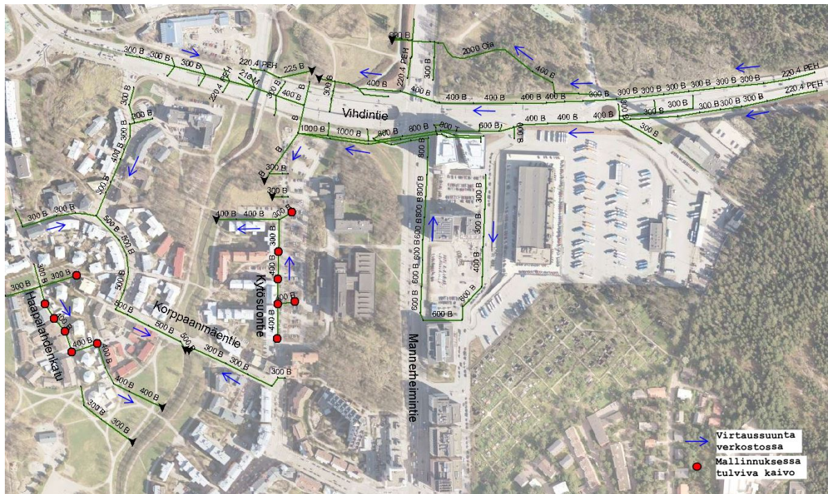
Kuva 3.1. Kerran 5 vuodessa toistuvan mitoitussateella (15 min, 250 l/s/ha) tulvivat kaivot Vihdintiellä ja sen eteläpuolella.
