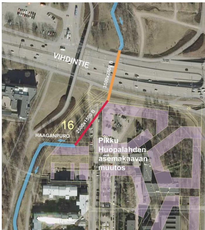
Kuva 2. Haaganpuron Vihdintien alittava nykyinen siltarumpu. Siltarummun koko oranssilla, uudella osuudella 3,5x2,5 m ja punaisella vanhalla osuudella 2,5x1,5 m. Sininen osuus on avouomaa.
