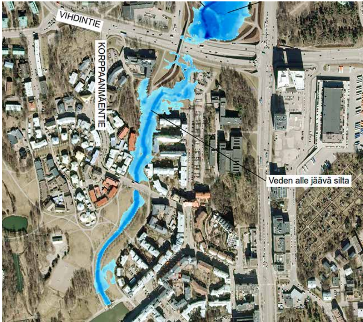
Kuva 7. Nykytilanteessa kerran 50 vuodessa toistuvan sateen aiheuttama tulva-alue Vihdintien eteläpuolella. Uoman, rumpujen ja silta-aukkojen on oletettu toimivan ongelmitta.
