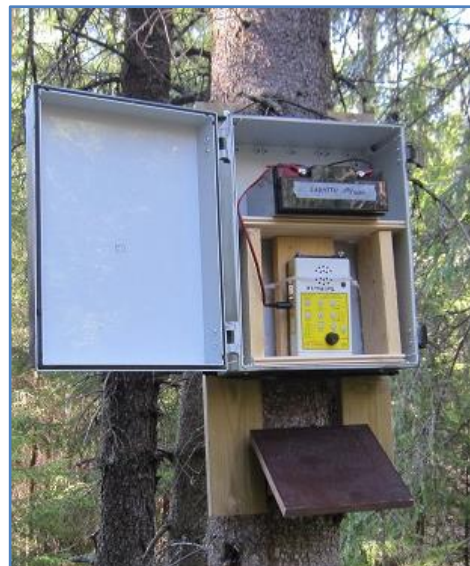
Kuvat 1 a ja b. Passiiviseurantadetektorit säänkestävässä kaapissa.
