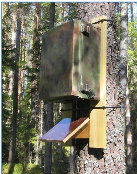
Kuvat 1 a ja b. Passiiviseurantadetektorit säänkestävässä kaapissa.
