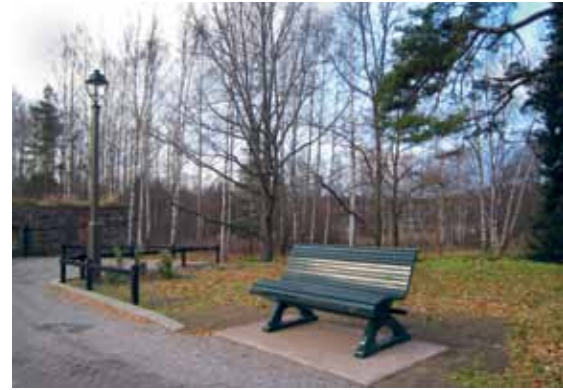
Kuva 94. Nordsjön kartanopuiston istuimiksi valittiin perinteiset puusohvat. Ne kiinnitettiin betonialustoille, jotka tulee peittää käytävän pintamateriaalilla. Matti Liski.
