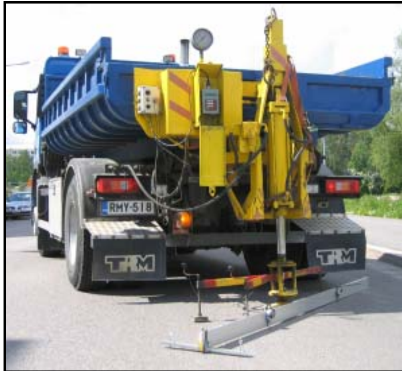
Kuva 2. Vertailututkimuksessa käytetty levykuormituslaite ja vastapainona toimiva kuorma-auto. Kuvasta on nähtävissä laitteen ohjaus- ja tallennusyksikkö, hydraulinen tunkki, kuormituslevy ja mittausanturin tukikehikko sekä oikolauta, jota käytettiin taipumasuppilon muodon määrittämiseen.
