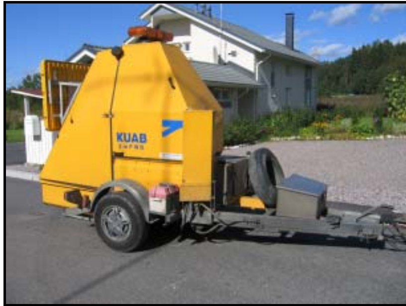
Kuva 4. KUAB 50 -pudotuspainolaite traileriin asennettuna.
