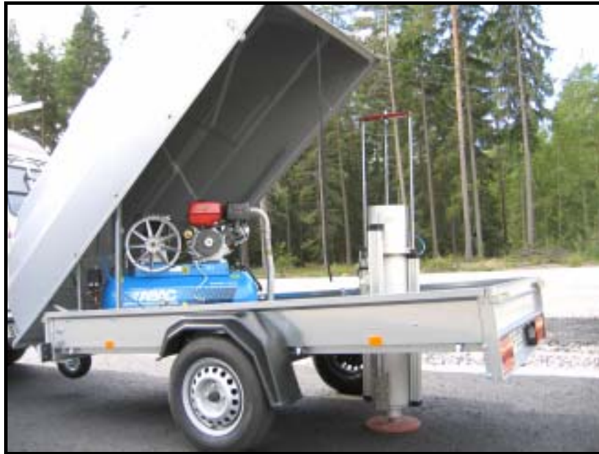
Kuva 3. Heavy Loadman -pudotuspainolaite ja sen kuljettamiseen käytettävä peräkärri. Kuvasta on nähtävissä kompressori, kuormituslevy sekä pudotuspainon nostin, joka on paineilmatoiminen.
