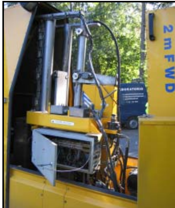
Kuva 5. KUAB-pudotuspainolaite suojakansi avattuna. Kuvasta on nähtävissä pudotuspainon nosto- ja ohjauslaitteisto sekä laitteen kytkentärasia.
