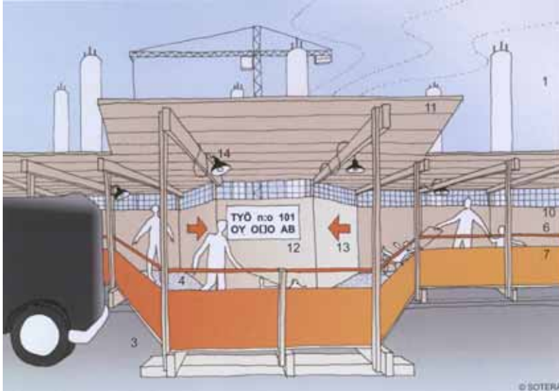
Kuva 28. Esimerkki 1 työmaan esteettömistä liikennejärjestelyistä /11, s. 24/.
