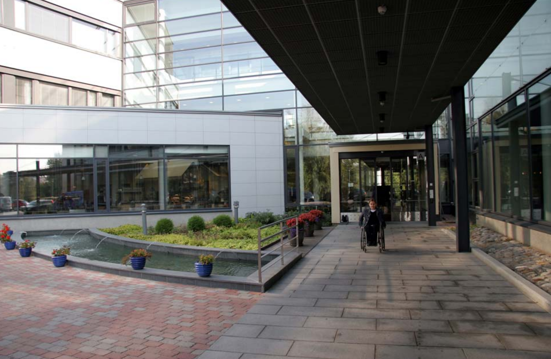
20. Suihkulähteen solina auttaa näkövammaista henkilöä löytämään sisäänkäynnin. Maan tasossa olevassa esteettömässä sisäänkäynnissä on automaattiset liukuovet. Sisäänkäynti on katoksessa. (Synapsia)
