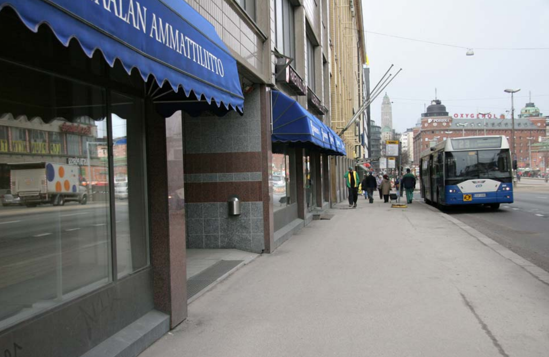
19. Ovi on näkövammaisen henkilön helpompi löytää, jos se sileän julkisivun sijasta on syvennyksessä. Syvennyksen voi havaita kuulon avulla, kun äänet heijastuvat siitä eri tavalla kuin sileästä julkisivusta. (Siltasaarenkatu)
