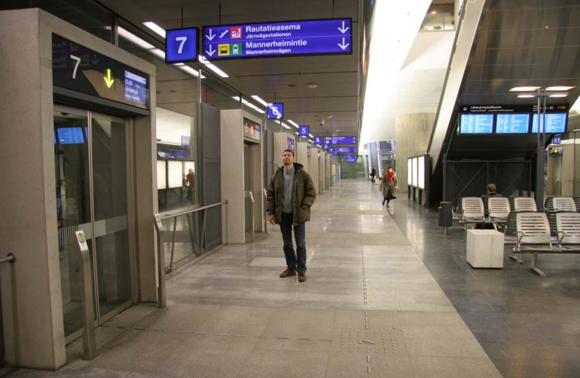
9. Jos opaste on kulkuväylän yläpuolella, vapaa korkeus sen alla tulee olla vähintään 2200 mm. Näin sijoitetun opasteen informaatio ei ole näkövammaisten henkilöiden saavutettavissa. (Kampin keskus)
