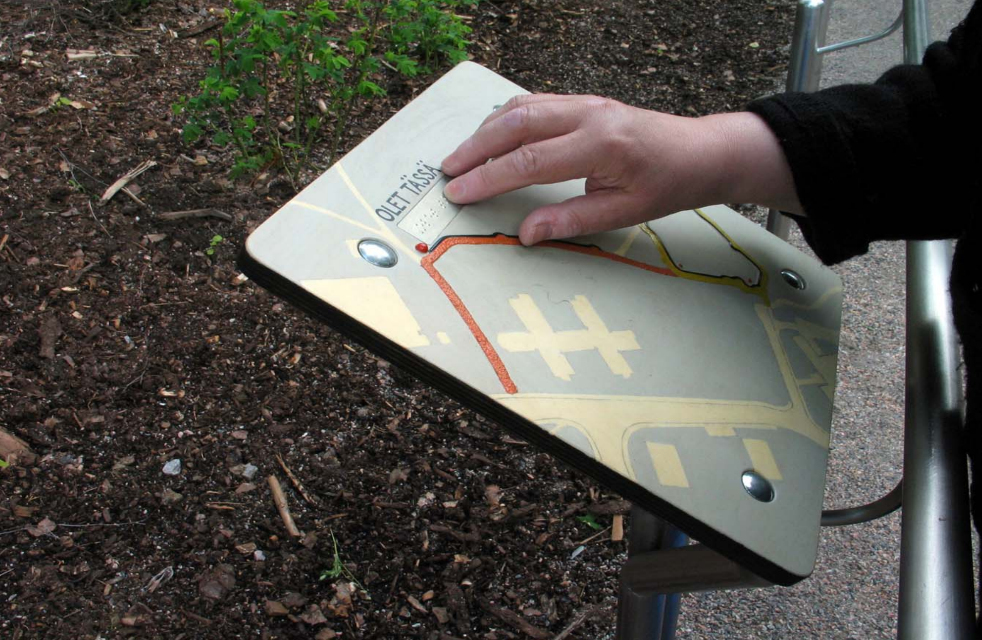
12. Pieni kohokartta osoittaa kulkureitin puistossa. Kartassa on myös hyvä värikontrasti. se sijoitetaan 1300–1400 mm:n korkeudelle maasta vinoon asentoon. (Maunula)
