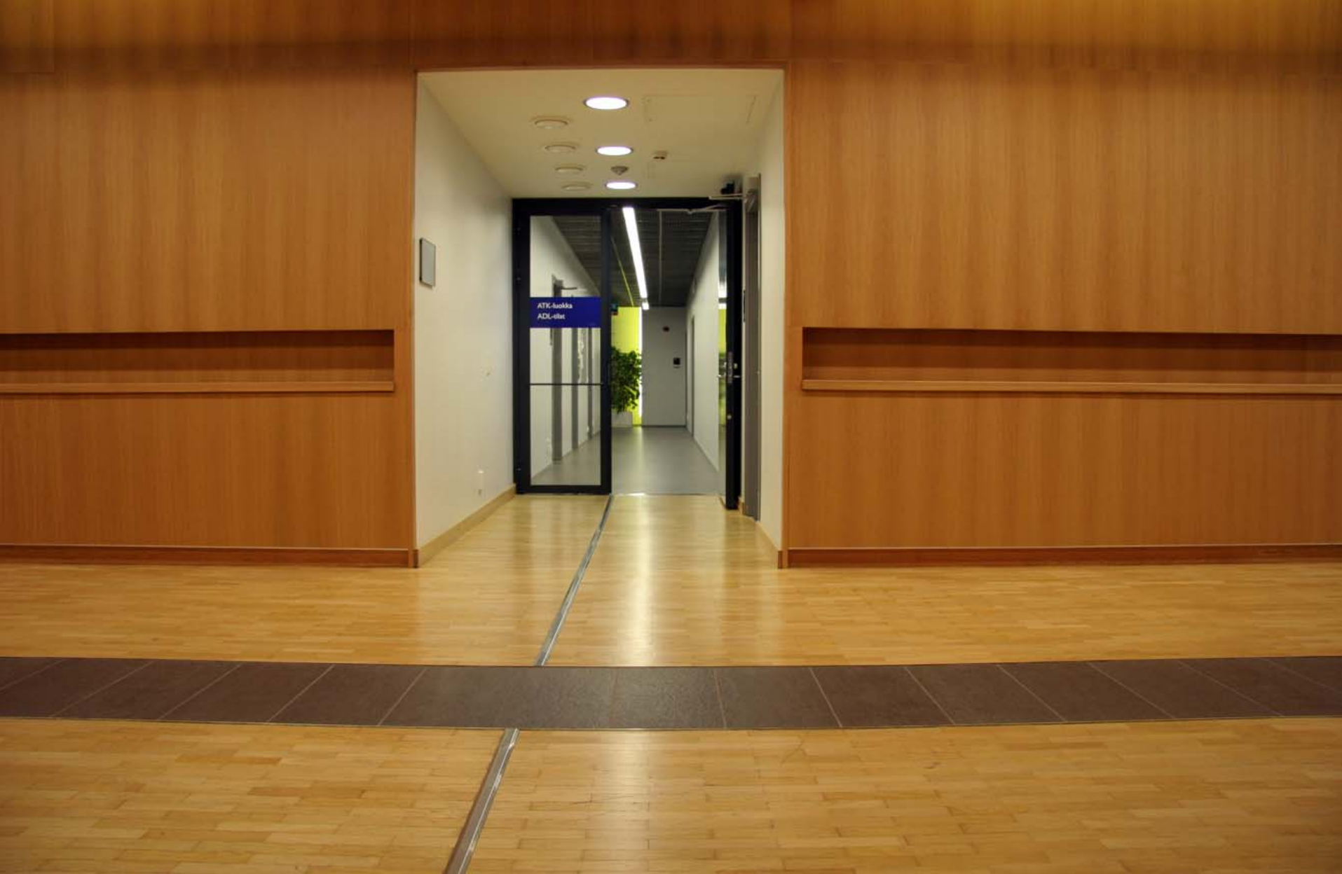
18. Materiaali- ja värikontrastit käytävässä ohjaavat näkövammaista henkilöä. (Näkövammaisten palvelu- ja toimintakeskus Iiris)
