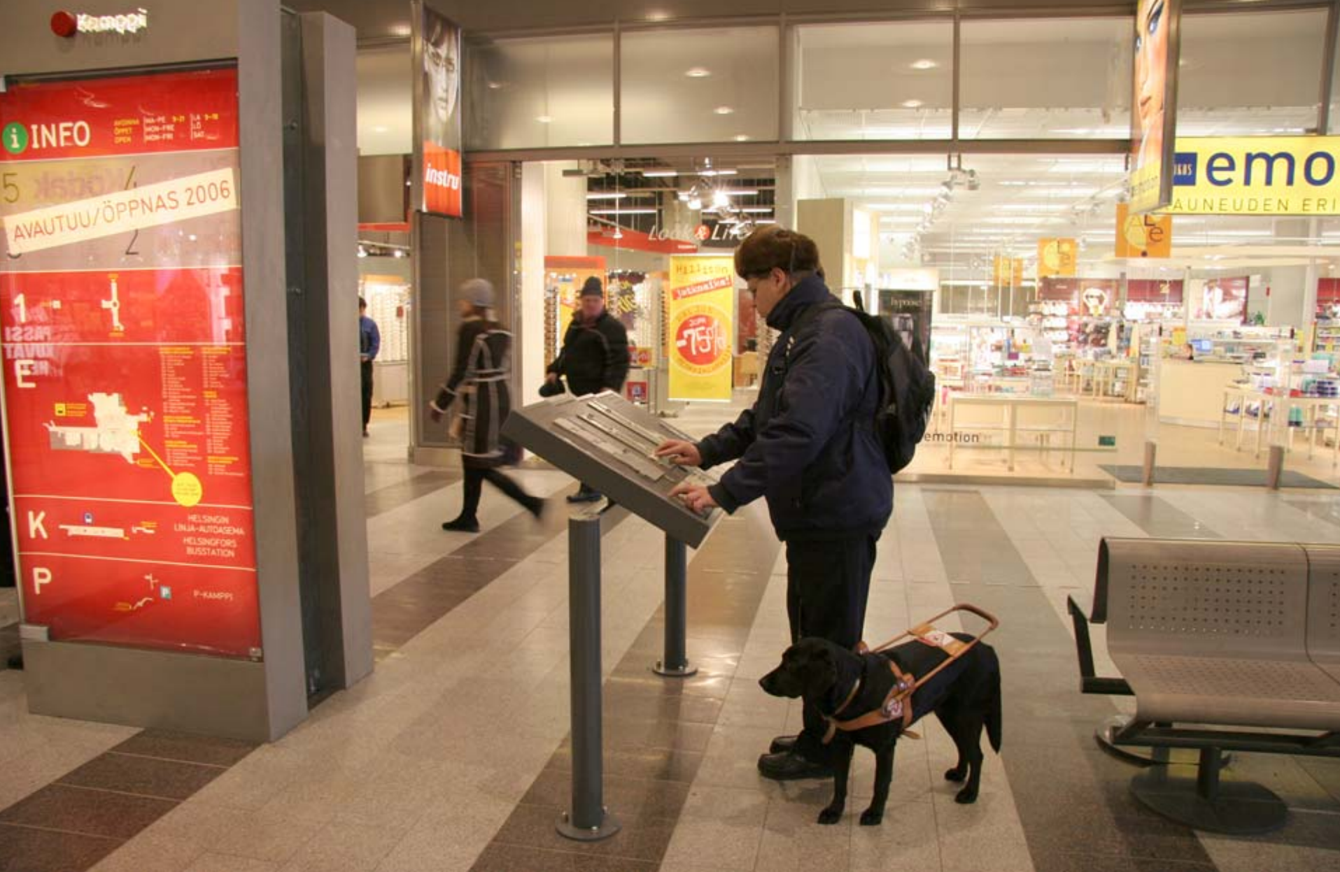
14. Näkövammaisille suunnitellut Kampin keskuksen opasteet on sijoitettu vinoon asentoon, jotta niitä voi lukea sormin. (Kampin keskus)
